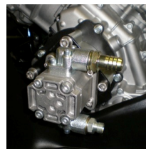
Pump monterad direkt på ATV motor
