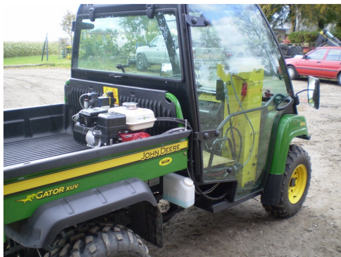
Hydraulsystem där pumpen drivs av 5 hk Honda bensinmotor.
