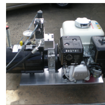
Hydraulsystem där pumpen drivs av 5 hk Honda bensinmotor.
